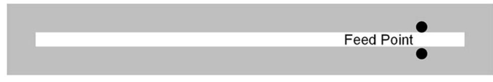
HALF WAVELENGTH SLOT ANTENNA
